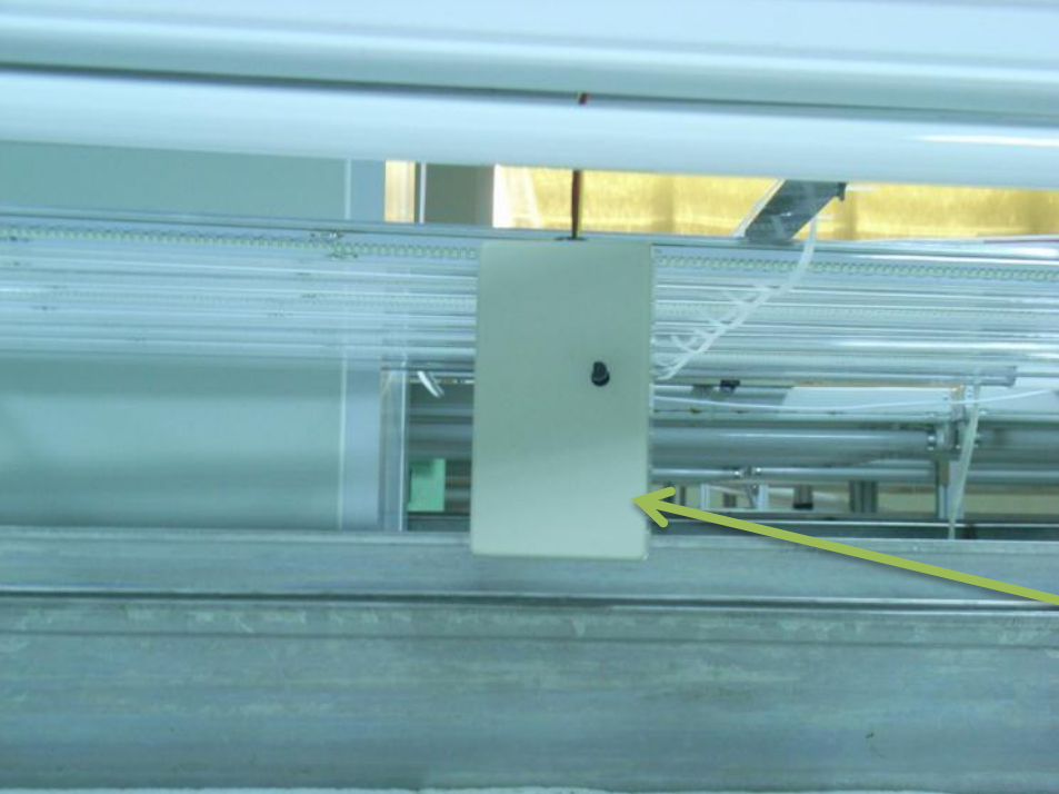
溫度感測器 吊掛於床架上 接近作物區
