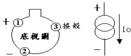
圖 5-17a AD590 感溫 IC 的接腳圖及零件符號
