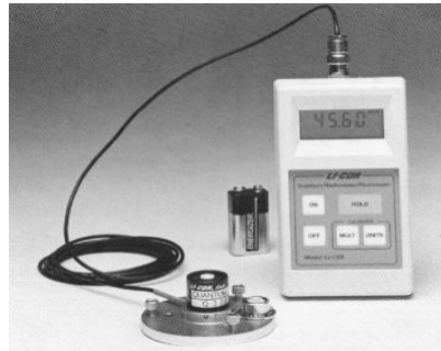
圖 5-4b 輻射感測頭 (Py 字首)、照度感測頭 (Ph 字首)、光量子數感測頭 (Q 字首) 與訊號讀取儀
