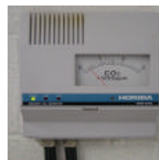
圖 5-20c 安裝於溫室的二氧化碳感測器(Horiba)
