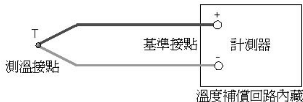
圖 5-9 熱電偶直接連接計測器
