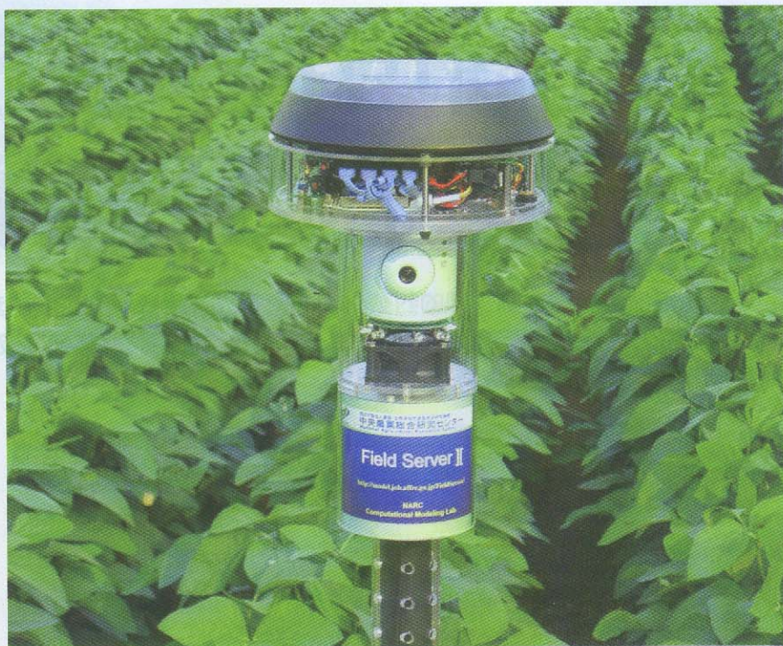
▲ 田間伺服器由日本農業綜合研究所創，內包含各類感測器、電源供應器、網路攝影機、儲存設備、及無線通訊模組，通常置放於戶外空曠地。
