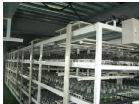
圖 6. 往復式自走光照裝置安裝於植床上
