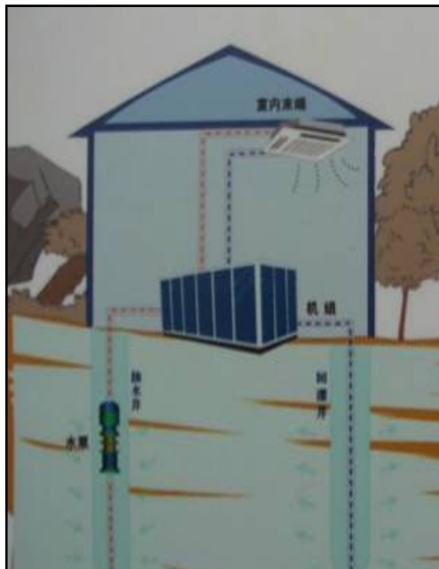
地下水地源熱泵系統
