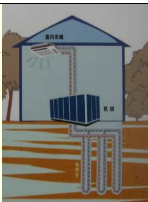
地埋管地源熱泵系統 30
