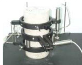
圖 30. 線性差動轉換器
