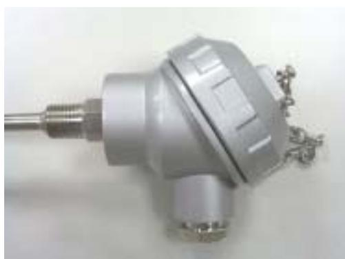
圖 17. 白金測溫電阻體之頭部構造實體圖
