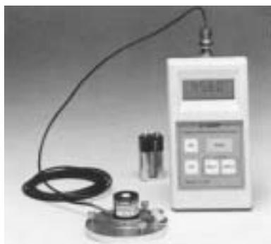
圖 3b. 輻射感測頭 (Py 字首)、照度感測頭(Ph 字首)、光量子數感測頭(Q 字首)與訊號讀取儀器
