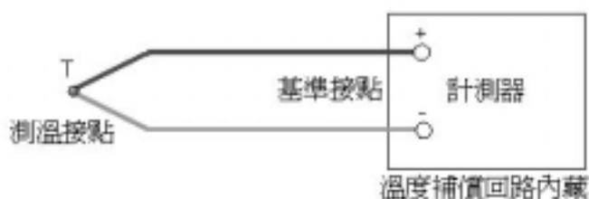
圖 11. 熱電偶直接連接計測器
