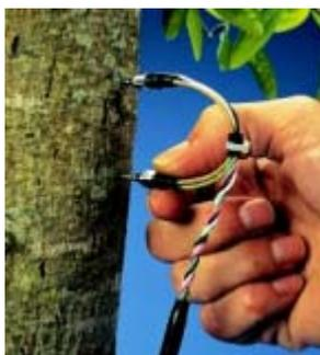
圖 28a. 木液流速感測器
