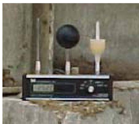
圖 32. 乾球/黑球/濕球溫度量測儀
