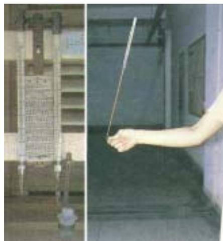
圖 5a. 乾濕球溫度計
