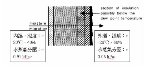
使用絕熱材料於牆壁中將使外壁溫還低於未使用絕熱材料時的外壁溫。較低溫時的飽和蒸氣壓為較低,於是水份更容易凝結。如上圖所示,在靠近外壁的內側即開始有水份凝結,此表示在較溫暖高濕的一側的牆內加裝一層防水的材料是必需的。
