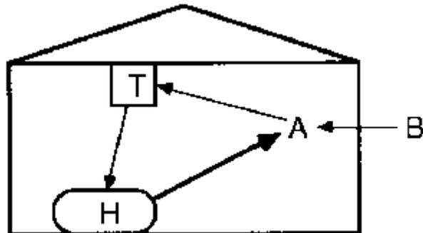
一般包括加熱與通風的溫度控制系統如圖 10-1 所示，外溫與室內之其它熱源影響建築物之散熱情況，直接影響內溫。內溫與恆溫器之設定值控制通風口、風扇與加熱器之開閉。通風口、風扇與加熱器對室內溫度的影響屬於負回授(饋)控制(negative feedback control)，負回授(饋)代表此次的動作幅度愈大，下次所需的動作幅度則愈小。
