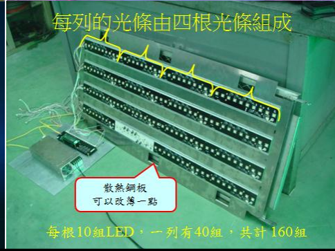
植床底座安裝光盤 側面安裝控制器與顯示面板
