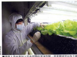
使用人造光再加上完全密封的潔淨空間，蔬菜變成可以在工廠內生產與控制的產品。
